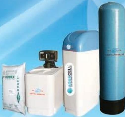
Yumuşatma sistemi; suda bulunan kalsiyum, magnezyum iyonlarından kaynaklanan sertliğin katyonik reçine kullanılarak bu iyonların kireçlenme ve çökelme yapmayan sodyum tuzlarıyla değiştirilerek sudan uzaklaştırılması işlemidir.
